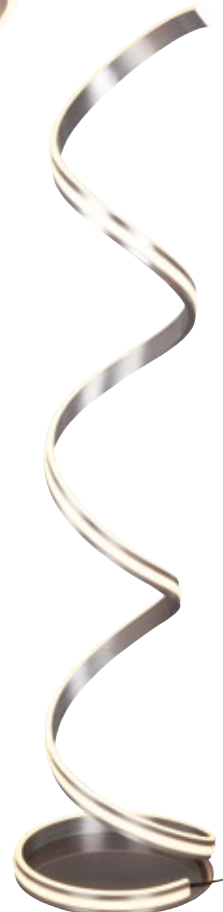
2011582. Nickel, mit Switch-Dimmer, Lichtfarbe einstellbar, mit Fußschalter, 60 W LED, 2300/3000/4000 K, 4000 lm, H 1500, D 350 € 350,90
